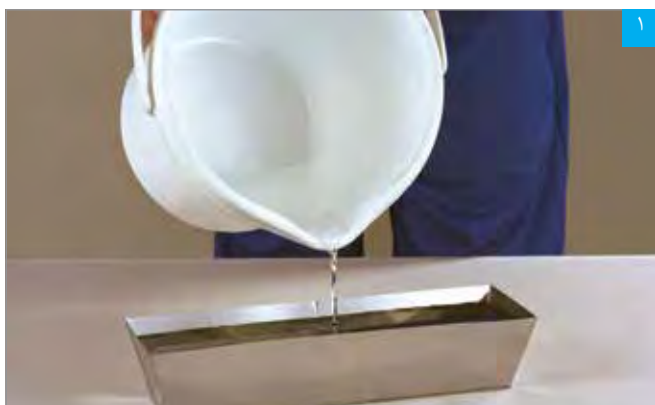
ریختن آب در ظرف تهیه بتونه
