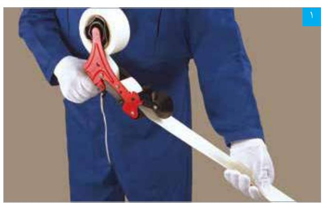
خم کردن نوار درزگیر با دستگاه تازن
