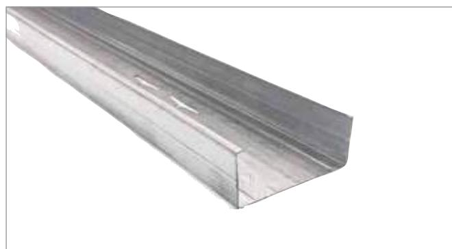
سازه استاد، جزء عمودی ساختار قاب فولادی را در دیوارهای خشک تشکیل می‌دهد. این سازه‌ها به صورت قائم و در فواصل ۳۰، ۴۰، ۵۰ یا ۶۰ سانتی‌متر از یکدیگر نصب شده و به عنوان زیرسازی برای نصب پنل‌ها عمل می‌نمایند. مقطع این پروفیل C شکل بوده و در اندازه‌های ۷۰، ۷۵ و ۱۰۰ میلی‌متر (عمق جان) و در دو نوع بر اساس استانداردهای NF و DIN تولید و عرضه می‌شود.
