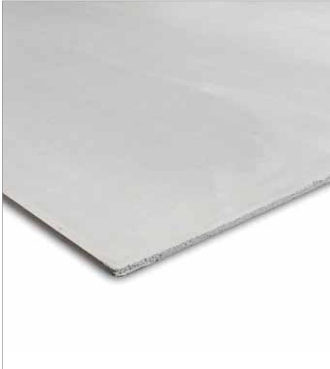
۲.۲. صفحات مسلح سیمانی صفحات مسلح سیمانی ترکیبی از سیمان پرتلند، پرکننده‌های ویژه و مواد افزودنی خاص بوده که پشت و رو و لبه‌های طولی آن‌ها به وسیله شبکه‌ای از الیاف شیشه مسلح شده است. این صفحات در انواع خارجی و داخلی تولید شده که به ترتیب در دیوارهای خارجی (نمای)، فضاهای داخلی و سقف‌های کاذب که در معرض رطوبت با درصد بالا و یا آب ریزی مدام هستند (مانند آشپزخانه‌های صنعتی، استخر و سونا)، به کار می‌روند.
