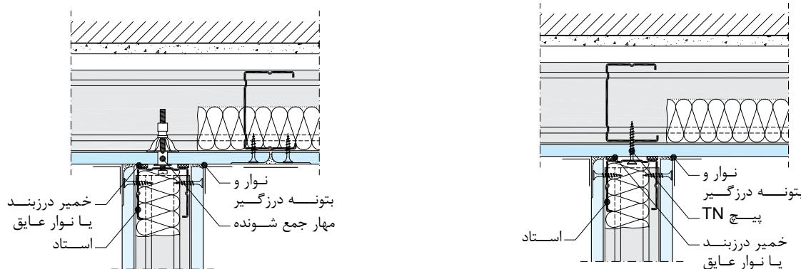
اتصال دیوار جداکننده به دیوار پوششی W626.ir
