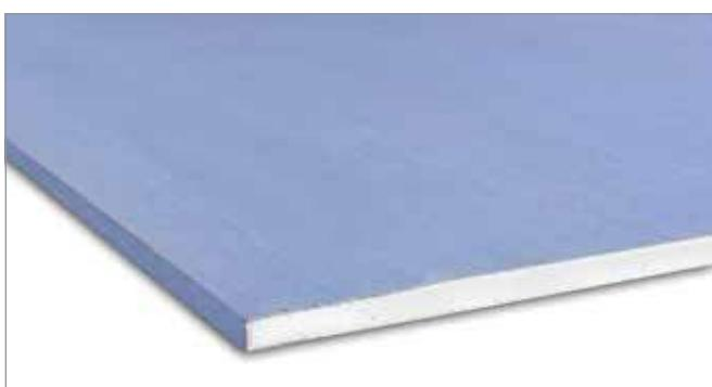
۵.۱.۲. پنل گچی مقاوم در برابر ضربه این پنل از یک هسته گچی اشباع و روکش کاغذی مقاوم در هر دو سمت آن تشکیل شده است. ویژگی‌های این پنل باعث شده است بتوان به ساختاری با استحکام و مقاومت مکانیکی بالا دست یافت، در عین حال موارد مربوط به عایق‌بندی صوتی، حرارتی و مقاومت در برابر حریق آن حفظ شود.
