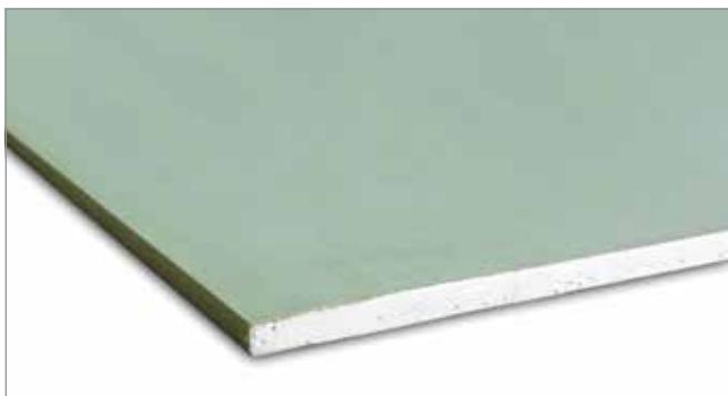
۴.۱.۲. پنل گچی مقاوم در برابر حریق و رطوبت (GKFI یا FM) پنل‌هایی هستند که گچ تشکیل‌دهنده آن‌ها حاوی الیاف شیشه و مواد مقاوم در برابر رطوبت می‌باشد. پنل‌های گچی مقاوم در برابر حریق و رطوبت در محیط‌هایی که به طور همزمان خواص مقاومت در برابر حریق و رطوبت مورد نیاز باشد (مانند چاههای تاسیساتی)، مورد استفاده قرار می‌گیرند. این صفحات دارای روکش سبز رنگ می‌باشند.
